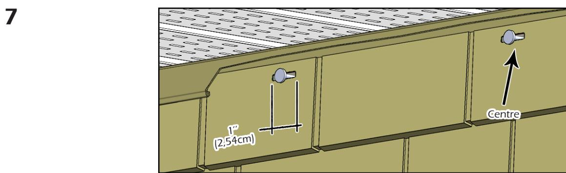
Si vous devez fixer les panneaux dans un endroit autre que dans les trous de fixation, faire une fente de 1"(2,54 cm) pour permettre de clouer. Toujours clourer au centre de la fente.
