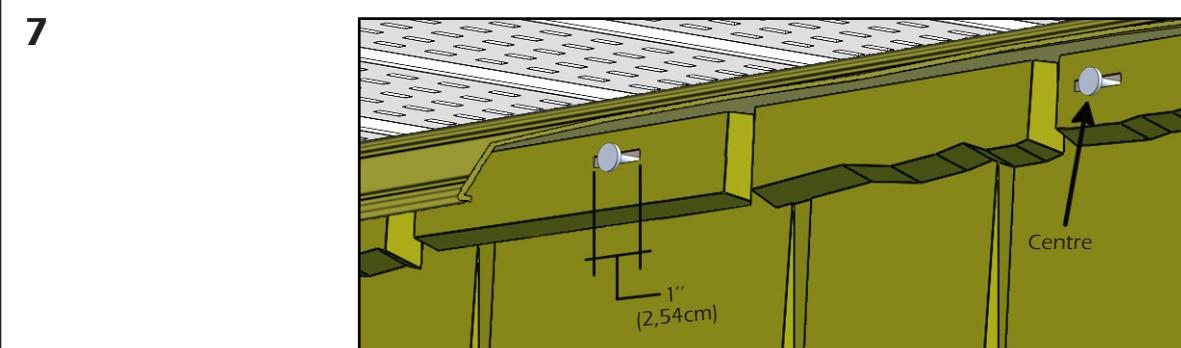
Si vous devez fixer les panneaux dans un endroit autre que dans les trous de fixation, faire une fente de 1"(2,54 cm) pour permettre de clourer. Toujours clourer au centre de la fente.
