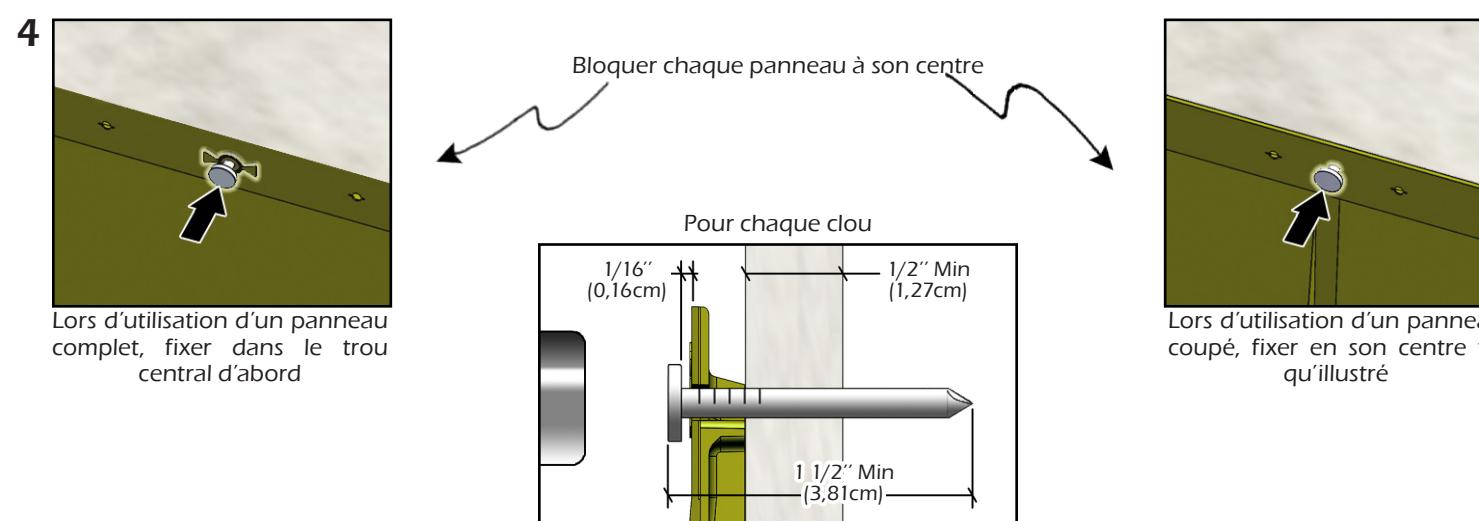
**5** Installation à une température extérieure supérieure à 40°F(5°C), arrêter à la butée/repère visuel.
